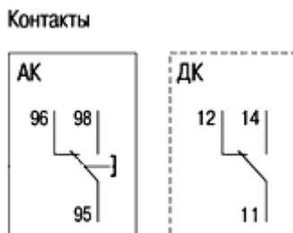
Рисунок 11 — Электрические схемы дополнительного и аварийного контактов
