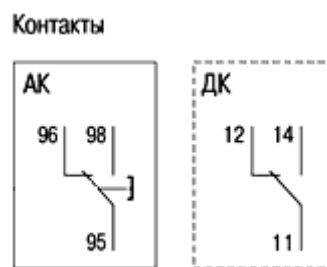
Рисунок 9 — Электрические схемы дополнительного и аварийного контактов
